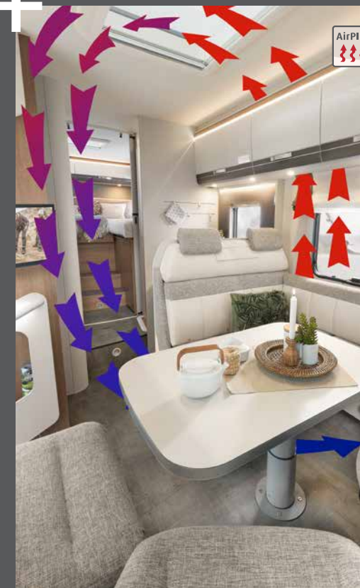
Het AirPlus systeem verhindert condensvorming achter de bovenkasten
