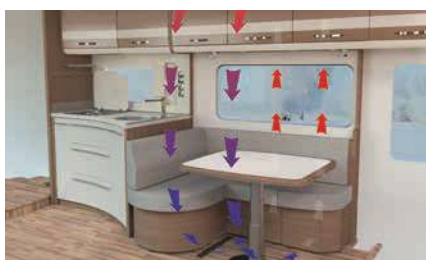
» Airplus – perfecte luchtcirculatie en ventilatie achter de bovenkasten en wandpanelen
