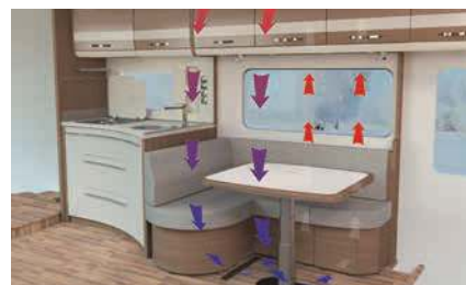
» Airplus systeem voor ventilatie achter de bovenkasten
