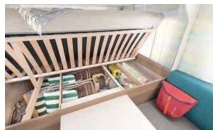
» De latten van de lattenbodem zijn geplaatst in rubber houders. Opklapbaar voor optimaal in- en uitladen.
