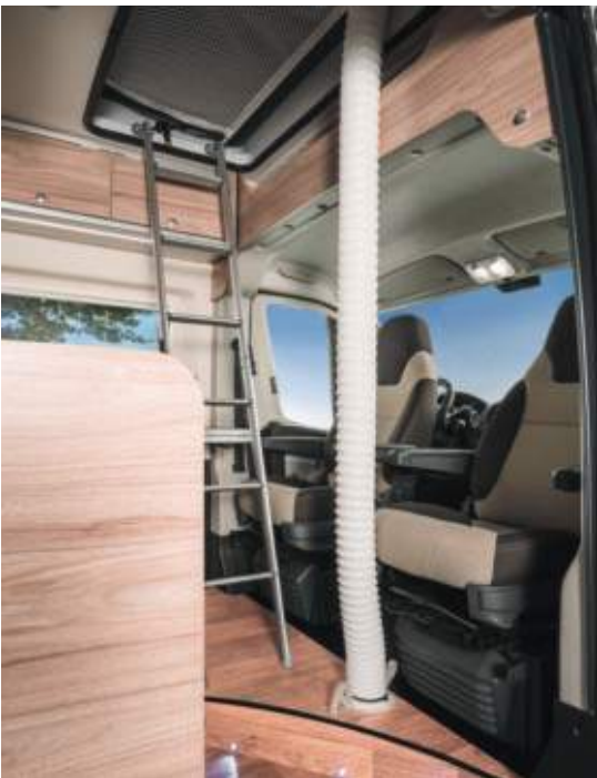
Een optionele warmeluchtslang dient om het gedeelte bij het uitzetdak van de HYMERCAR te verwarmen.
