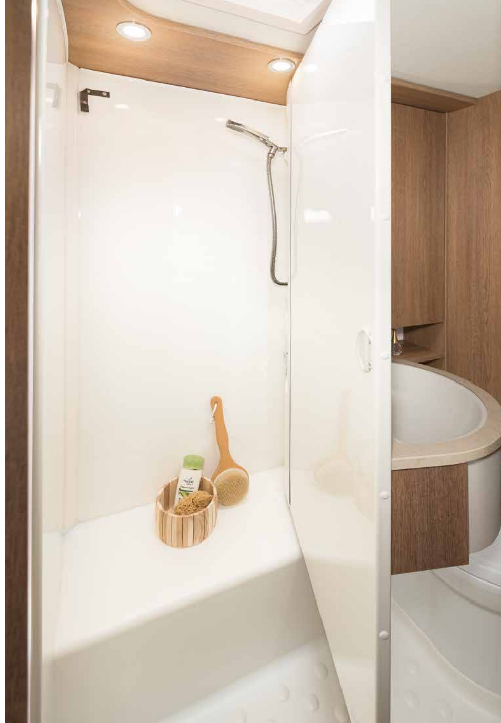
» Vario-bad met draaibare wand: met één draai een afzonderlijke douchecabine of toiletruimte // A 5887 & A 6977
