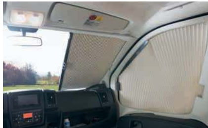
» I: De standaard aanwezige cabineverduistering, verduistert en isoleert gelijktijdig
