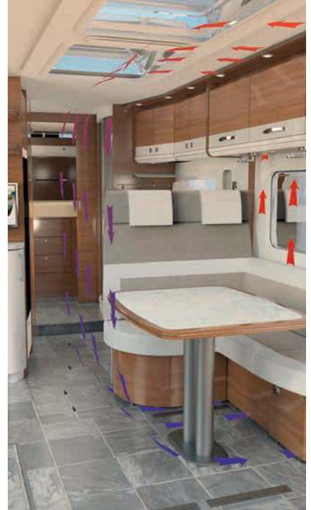
» Het AirPlus systeem voorkomt condensvorming
